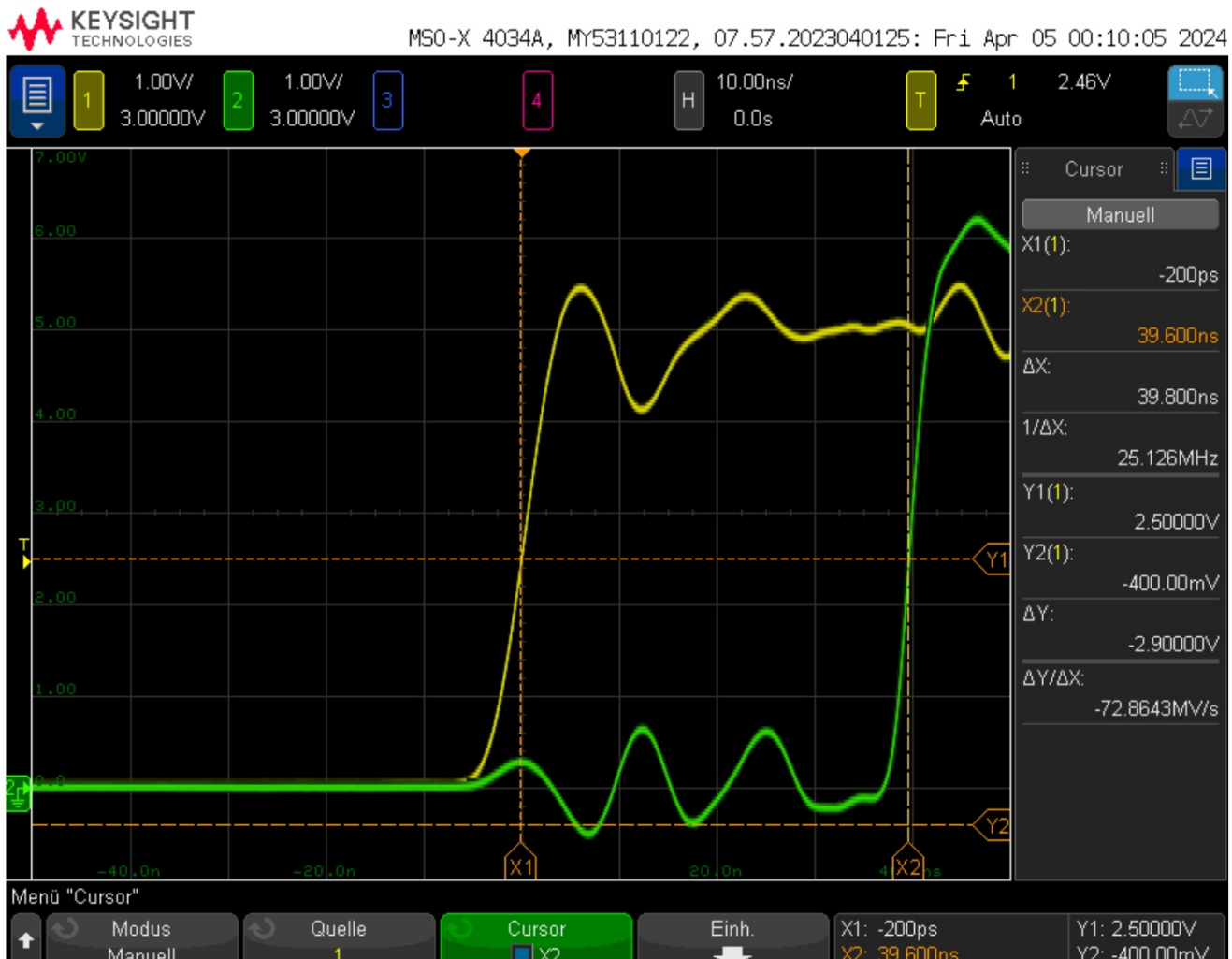
Abbildung 4: Screenshot vom Oszilloskop bei der Messung der Verzögerungszeit bei 5 V
