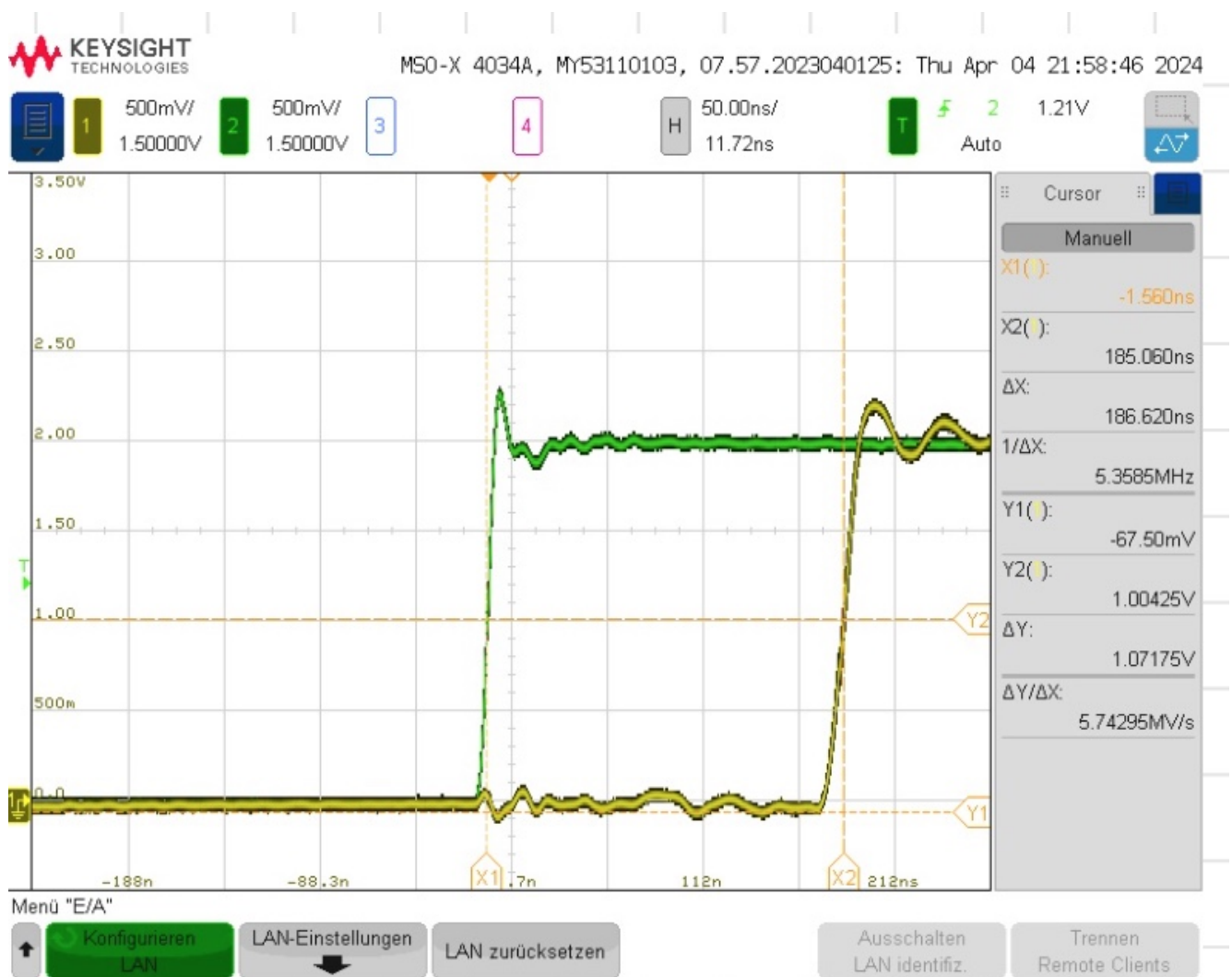
Abbildung 5: Screenshot vom Oszilloskop bei der Messung der Verzögerungszeit bei 2 V
